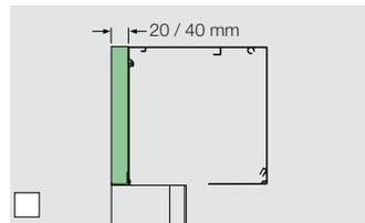
Kastendämmung rückseitig für Abstand-Führungsschiene mit 20 oder 40 mm
